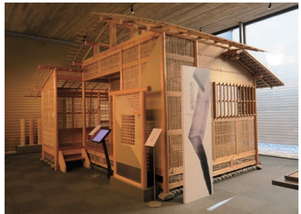
以奈良大德寺玉林院的簀庵為本，採傳統技法製作的茶室結構實景。
