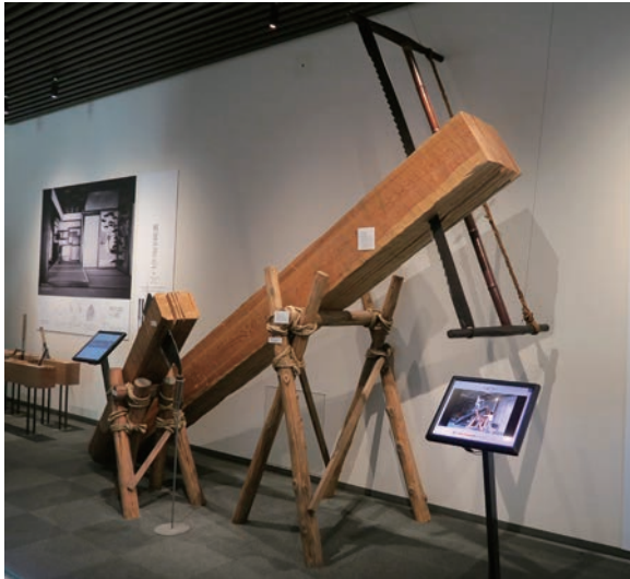
使用真實物件與工具，搭配影片，介紹如何使用大鋸分割木材。後方工具需兩人操作，後來演變成可一人操作的前方工具樣貌。
