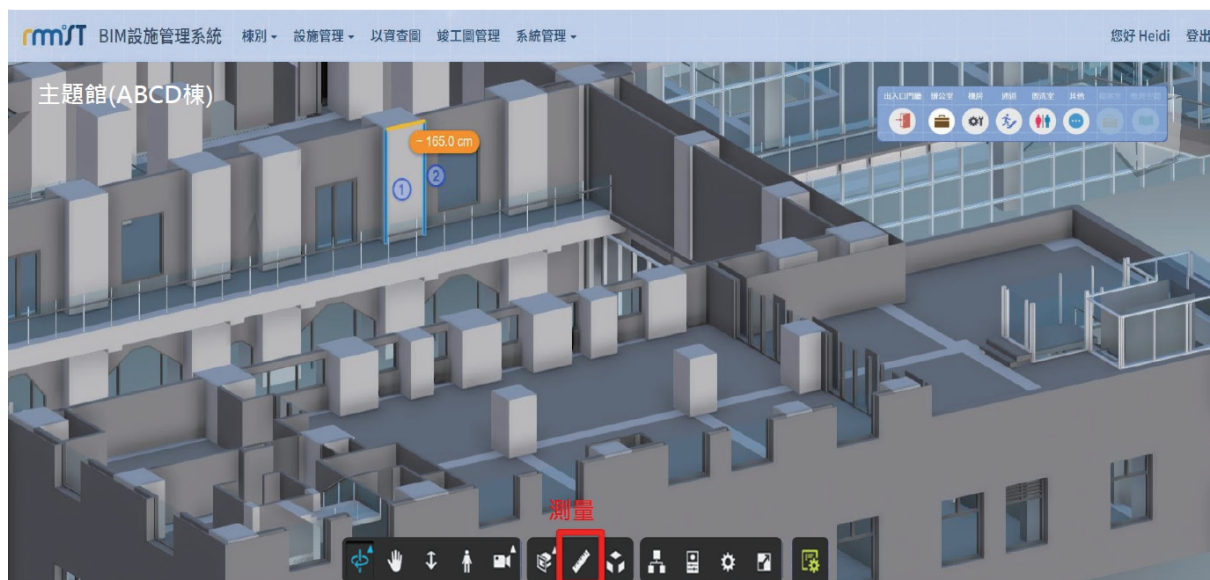
在 BIM 系統中，可以透過「測量」功能來量測任點距離，或是任二平面之角度。（圖片來源／國立海洋科技博物館 BIM 建置報告書）
