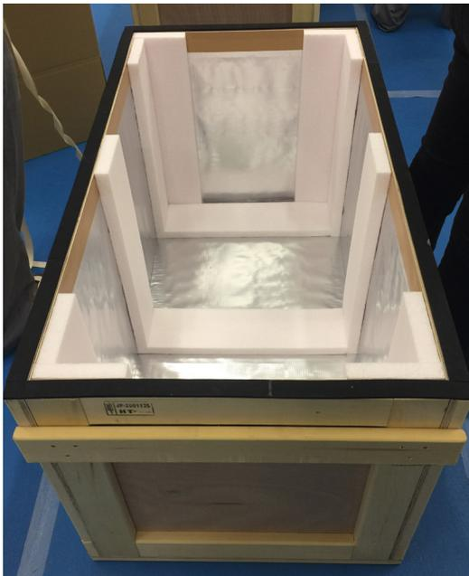
圖 4 內貼積層鉛箔可隔絕水份及木箱防止木箱板材釋出有害物
