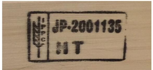
圖 2 經過加熱處理的板材上蓋有加熱證明印章
